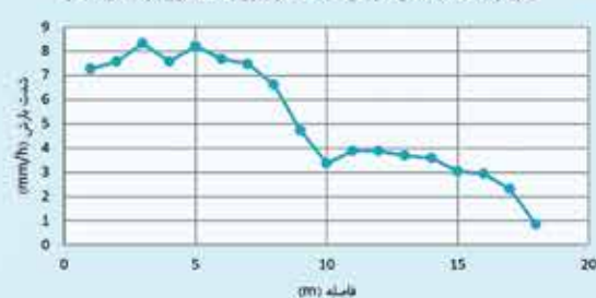
نمودار شدت پاشش آبپاش sr30 دو نازل تمام دور در فشار ۲ بار
